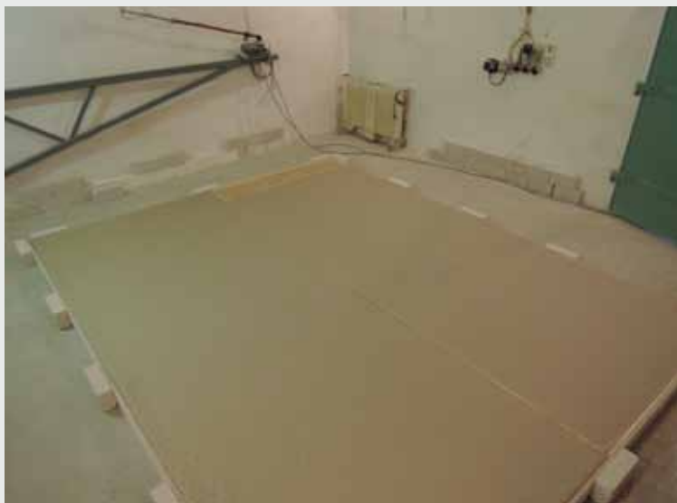
▼ Obr. 8. Laboratorní měření vzorku v dozvukové místnosti
